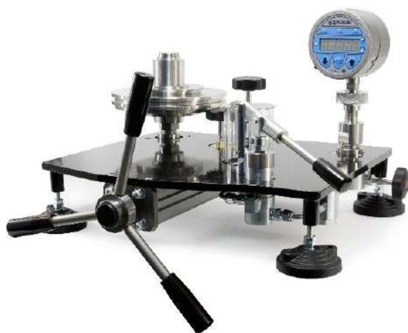
УСД исполнения для высокого давления
