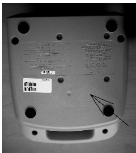
Рисунок 2 – Пломбы для защиты от несанкционированного доступа находятся на нижней поверхности измерителя. Стрелкой показано место нанесения знака утверждения типа
