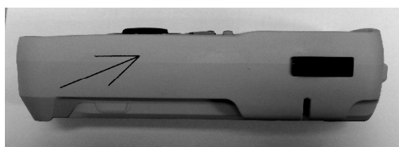
Рисунок 2 - Стрелками на боковой поверхности показаны места нанесения знака утверждения типа и поверительного клейма Справа видна защитная крышка на гнезде разъема mini-USB.
