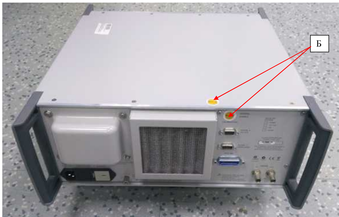
Рисунок 2 - Схема пломбировки от несанкционированного доступа (Б)
