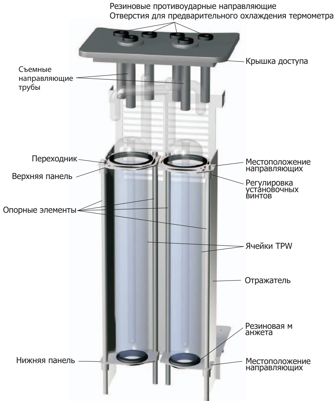
Рисунок 2. Сведения о крышке для доступа и стойках ячеек
