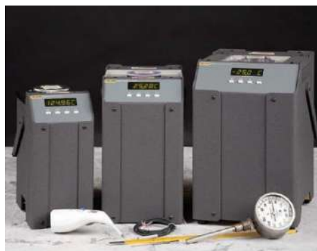
Микротермостаты, диапазон от -30 °C до 200 °C
