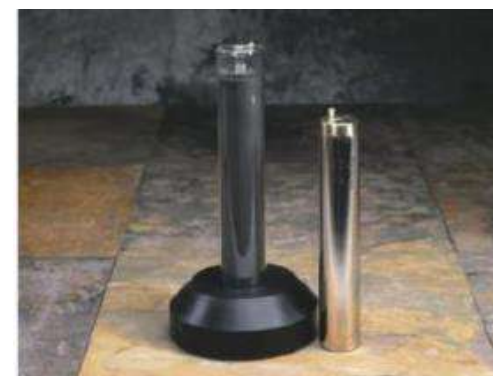
Мини-ампулы реперных точек МТШ-90: ТТВ, индий, олово, цинк, алюминий, серебро, медь
