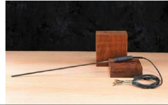
Первичные эталонные ПТС в металлическом корпусе, диапазон от -200 °С до 670 °С
