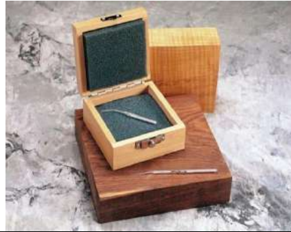
Эталонный миниатюрный капсульный термометр сопротивления, диапазон от -260 °С до 232 °С
