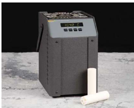
Калибратор термопар, диапазон от 150 °С
