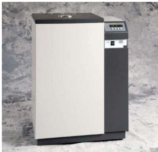
Печи для реализации реперных точек МТШ-90
