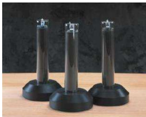
Ампулы реперных точек МТШ-90: ртуть, индий, олово, цинк, алюминий, серебро, медь, галлий
