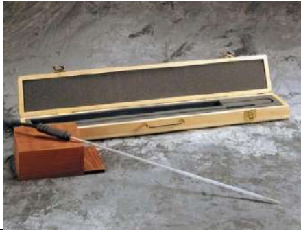
Первичные эталонные ПТС в кварцевом корпусе, диапазон от -200 °С до 1070 °С
