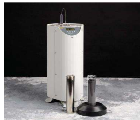
Печи реализации реперных точек МТШ-90 при помощи мини-ампул
