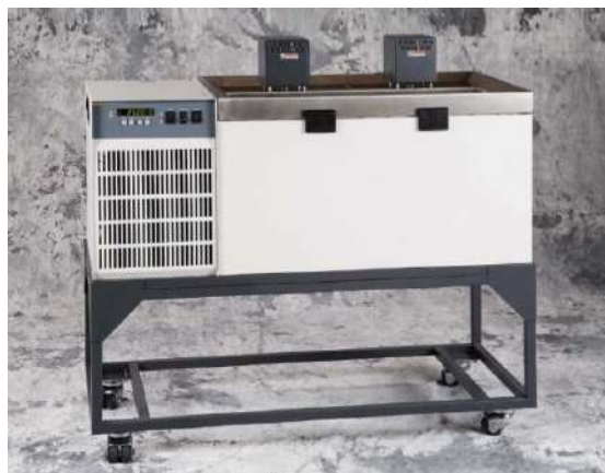
Ультростабильные термостаты для поддержания эталонов напряжения и сопротивления
