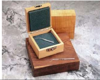
Эталонный миниатюрный капсульный термометр сопротивления, диапазон от -260 °С до 232 °С
