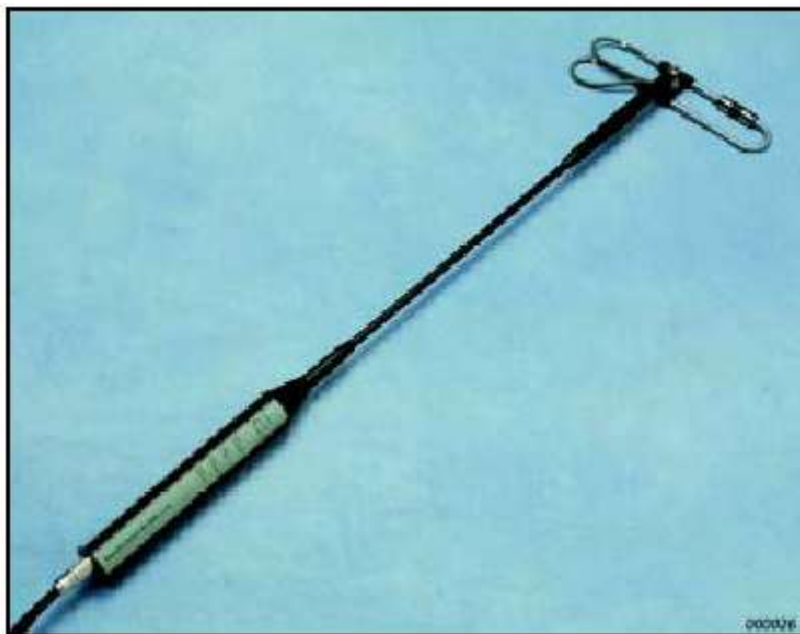
Рис. 3 Зонд для измерения интенсивности звука состоящий из: сдвоенного предусилителя (модель 2683) и микрофонной пары для измерения интенсивности звука (модель 4197). На рисунке зонд установлен на штангу-удлинитель.
