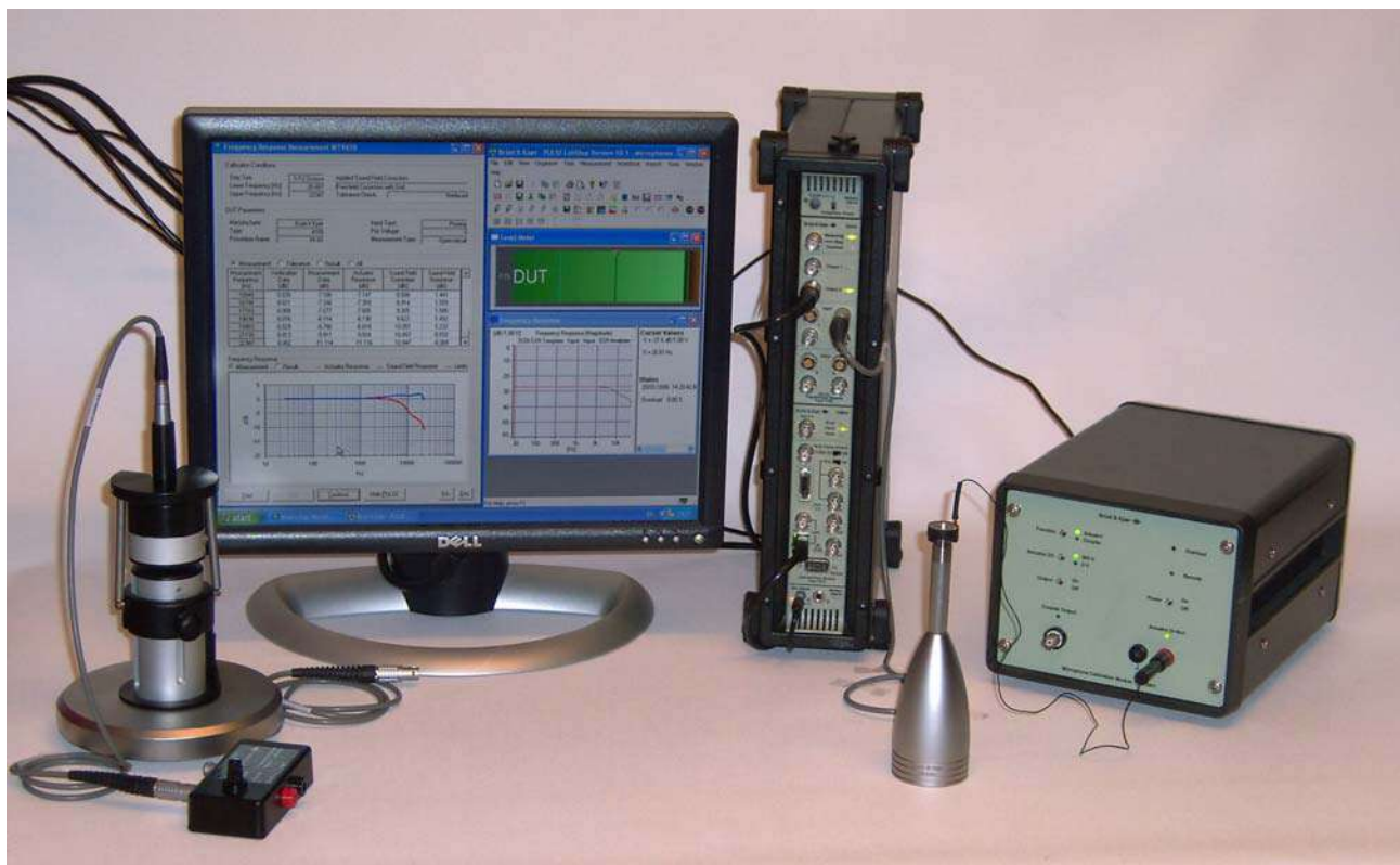
Система калибровки микрофонов типа 9721 на основе анализатора PULSE, стойка акустической камеры калибровки чувствительности (слева) и комплект электростатического актуатора (справа).
