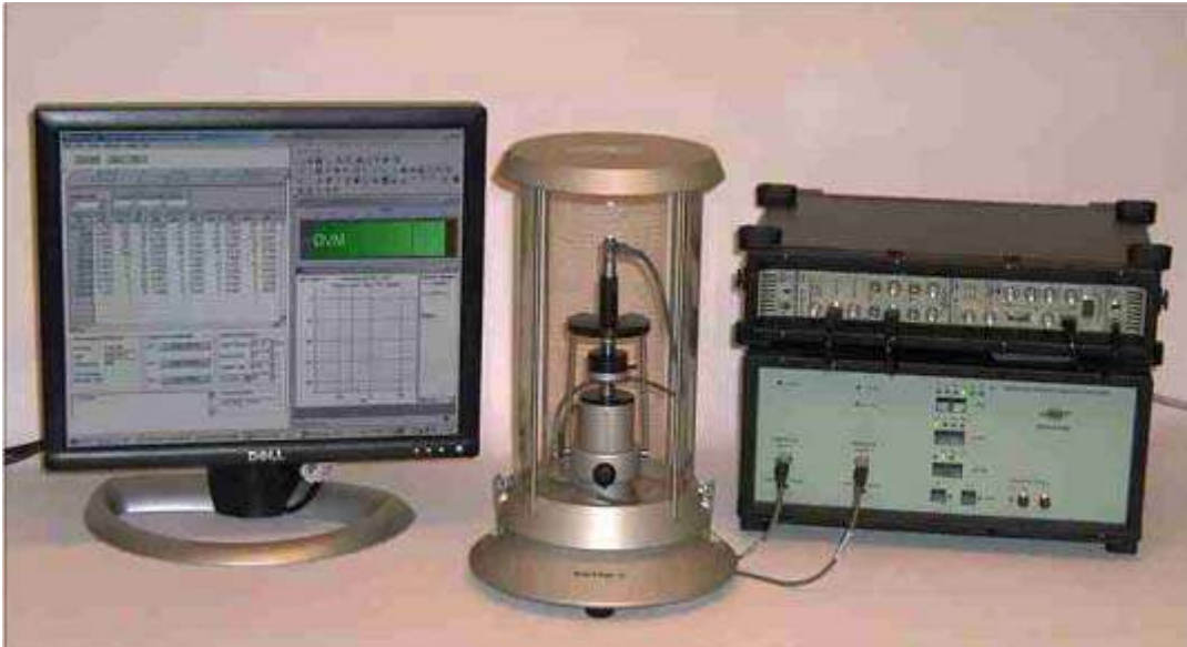
Основные приборы системы калибровки методом взаимности типа 9699 (слева направо и сверху вниз) — управляющий ПК, крепление микрофона UA1412, аппарат калибровки методом взаимности типа 5998 и анализатор PULSE типа 3560.
