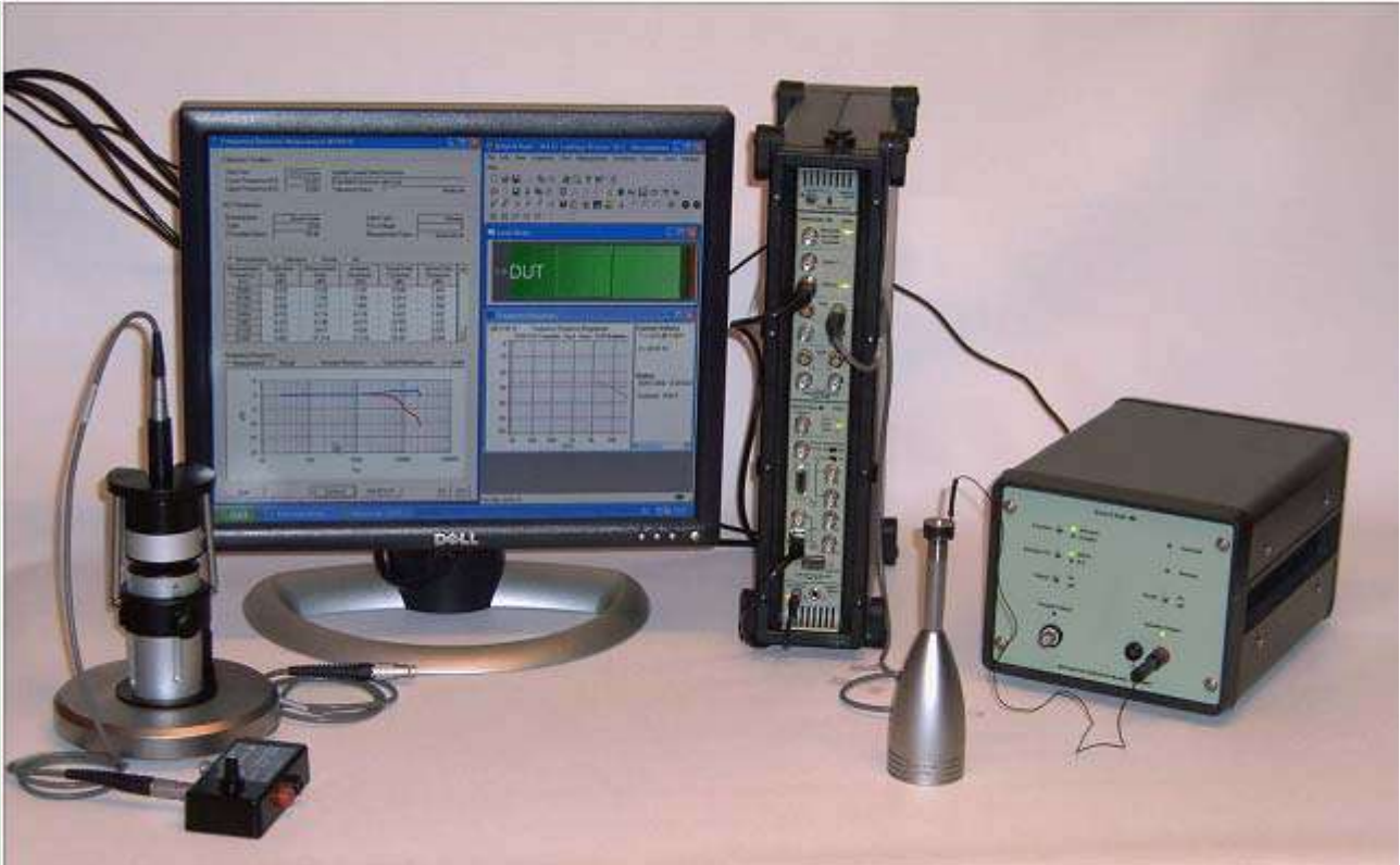
Система калибровки микрофонов типа 9721 с анализатором PULSE, стойкой камеры калибровки чувствительности (слева) и электростатическим возбудителем (справа).
