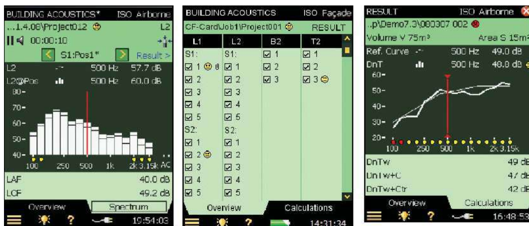
Рисунок 24. Примеры измерений в строительной акустике с помощью анализаторов типов 2250/2270: усредненный спектр L2 и спектральная величина L2 в одном положении (слева), общий список измерений (в центре); итоговый результат измерений (справа)
