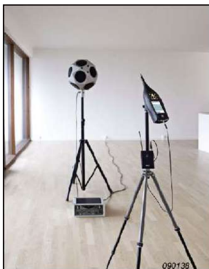
Рисунок 21. Измерение времени реверберации с помощью метода прерывистого шума
