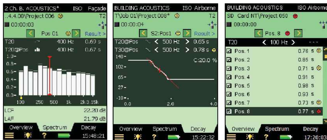
Рисунок 22. Спектр времени реверберации (слева), график спада звукового давления при реверберации (в центре) и общий список результатов (справа)
