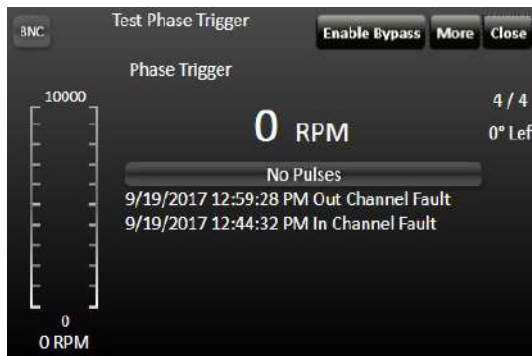
Рисунок 23-5) Отсутствуют триггерные импульсы
