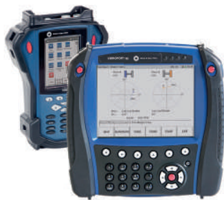
Дисплей анализатора вибрации VIBROPORT 80 оптимально подходит для выполнения балансировки на месте.
