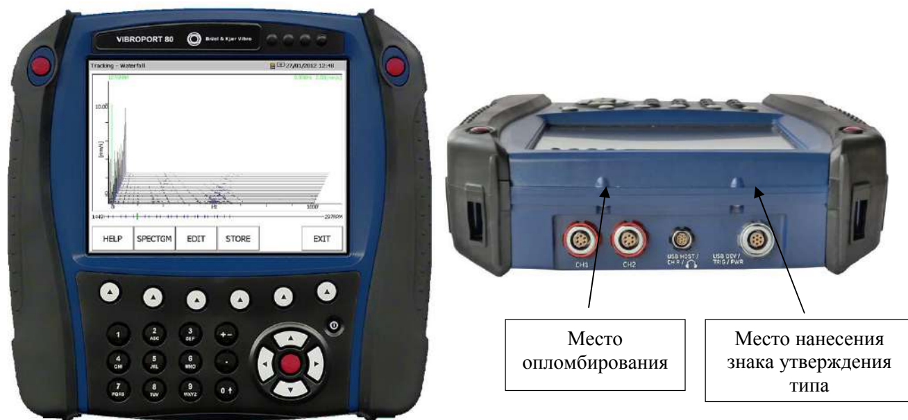
Рисунок 1 - Внешний вид анализаторов вибрации VIBROPORT 80
