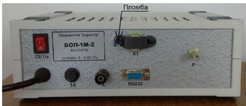
Рисунок 3 - Место пломбирования барометров образцовых переносных БОП-1М
