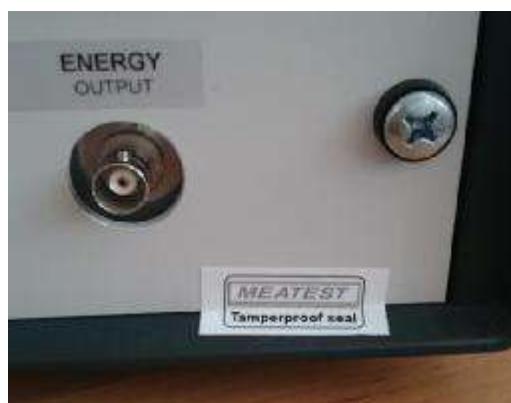
Рисунок 2 – Фотография пломбировки калибраторов
