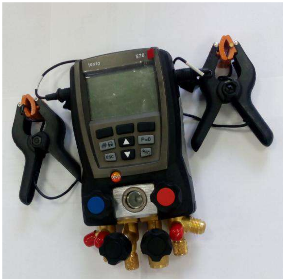
Рисунок 1 – Внешний вид измерителей давления цифровых Testo 570
