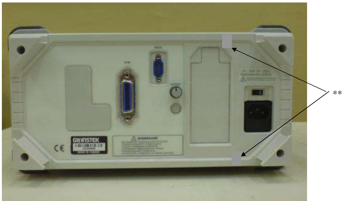
** - места пломбировки (нанесения наклеек) от несанкционированного доступа
