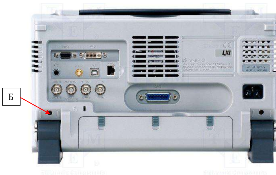
Рисунок 2 – Вид задней панели анализаторов и место пломбировки от несанкционированного доступа (Б)
