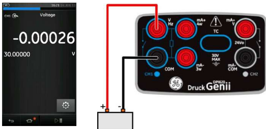
Рисунок 2-11. Измерение напряжения пост. тока или мВ пост. тока на CH1. Диапазон \pm 30 В
