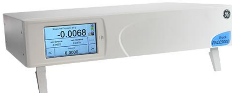
Рисунок 2 – Внешний вид калибратора давления PACE5000
