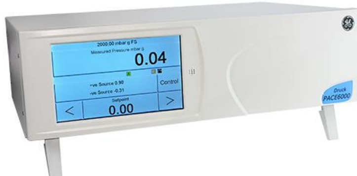
Рисунок 3 – Внешний вид калибратора давления PACE6000
