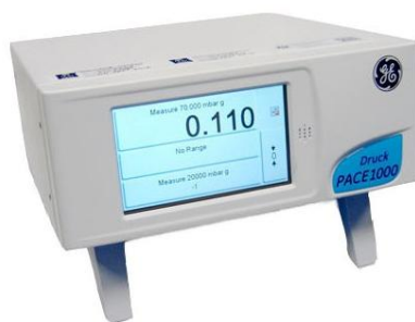
Рисунок 1 – Внешний вид калибратора давления PACE1000
