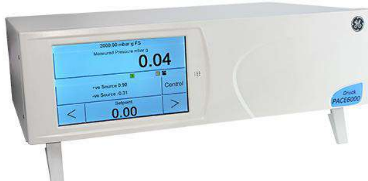
Рисунок 3 – Внешний вид калибратора давления PACE6000
