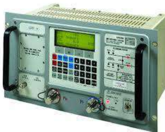
Рисунок 2 Прибор цифровой для проверки систем воздушных сигналов ADTS, модификации ADTS 405, ADTS 405 Mk2 панельной конструкции для установки в приборную стойку
